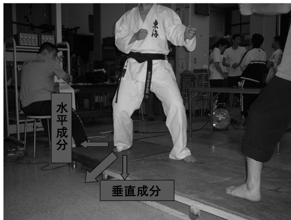
2台のフォースプレート上に前・後肢を合わせ、目標物として前方に対戦者を立たせた。間合いは各自の自由設定とし、中段逆突きを行わせ、前・後肢の床反力を計測した。
