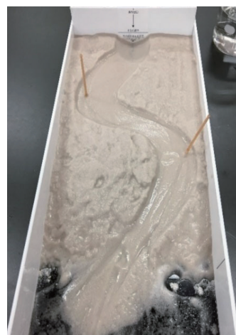
図3 流れる水のはたらき実験装置
